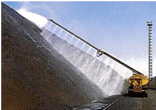
Gleichmäßiges Besprühen für Ausbildung einer geeigneten Kruste (BVT Lagerung)
